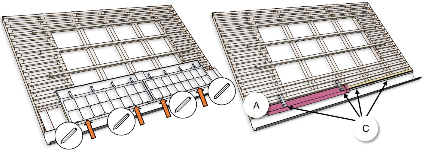
Die Unterkante des Solarbereichs an das Dach anlegen, die Eindeckungsprodukte an beiden Enden positionieren und die Position der Traufhaken gegenüber den Aussparungen rechts und links vom Rahmen markieren. Traufe auf die Eindeckungsprodukte ausgerichtet.
