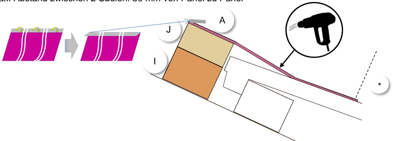
Die Unterkante des Solarbereichs an das Dach anlegen, die Eindeckungsprodukte an beiden Enden positionieren und die Position der Traufhaken gegenüber den Aussparungen rechts und links vom Rahmen markieren. \*Traufe auf die Eindeckungsprodukte ausgerichtet
